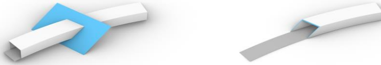
Abbildung 29 Schema zum Entwurfsprinzip für den abgeschrägten Portalrahmen. Massgebend ist die einheitliche Schnittfläche (blau)
