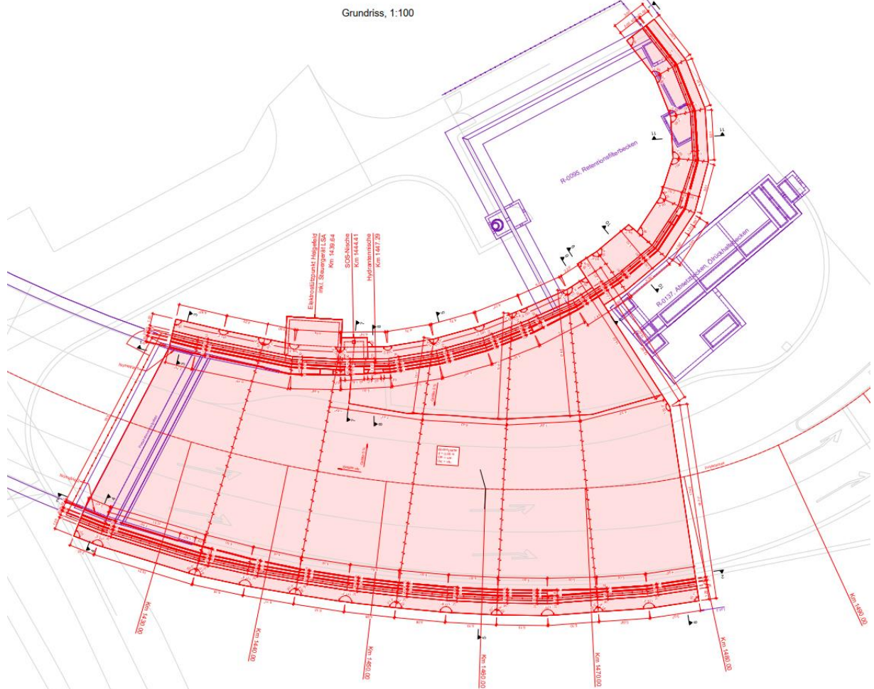
Abbildung 44 Grundriss Grundwasserwanne Helgefild
