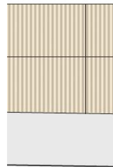
Abbildung 37: Flächen über Betonsockel aus Holz-Lärmschutzwänden
