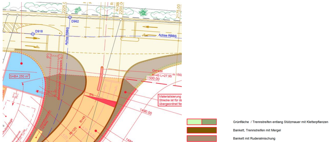
Abbildung 58: Exemplarischer Ausschnitt Knoten Helgefeld mit Bankettflächen gemäss Legende (Plan IG PRELO).
