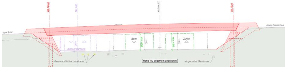
Abbildung 92: Längsansicht an N1-215 Überführung Langmattweg
